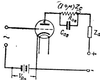
Рис. 4. Эквивалентная схема, замещающая схему, изображенную на рис. 3
