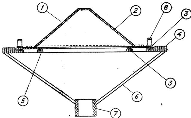
Рис. 1. Головка аппарата для отливки диффузоров без шва: 1—частая сетка с'емки части матрицы; 2—дыроробивная сетка с'емки части матрицы; 3—уплотняющее резиновое кольцо; 4—поддерживающее кольцо; 5—ребра поддерживающего кольца; 6—нижний конус; 7—втулка для присоединения головки к вакуумному насосу; 8—ручка
