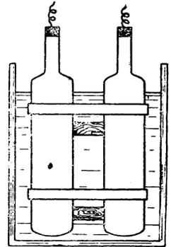
Рис. 3. Схематическое устройство анодного аккумулятора
