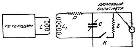
Рис. 1. Схема измерительной установки для определения  $R$
