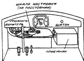
Рис. 2. Примерное расположение отдельных частей автомобильной радиостановки
