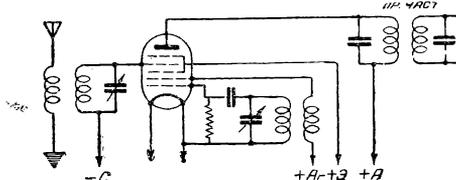
Рис. 3. Схема включения октода
