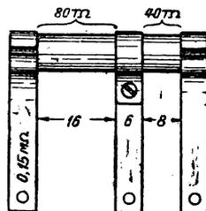
рины (см. рисунок). Излишек у нашего сопротивления 150 000—(40 000 + 80 000) равен 30 000 омов. Следовательно, ширина хомутика (30 000 : 5 000) должна быть равна 6 мм. При надевании хомутика нужно смыть спиртом (одеколоном) с поверхности сопротивления Каминского изолирующий слой лака.
