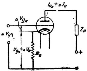
Рис. 1. Питание анодной и сеточной цепи от одного источника
