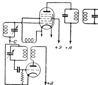
Рис. 5. Схема включения пятисеточного смесителя (по типу 6L7) с отдельным гетеродином (способ связи с гетеродином может быть выбран любой)
