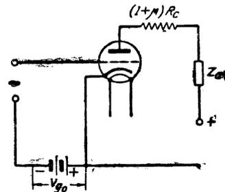
Рис. 2. Эквивалентная схема, заменяющая схему, изображенную на рис. 1
