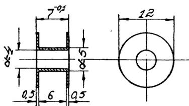
Рис. 6. Каркас катушки
