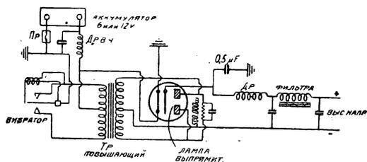
Рис. 4. Устройство преобразователя высокого напряжения с выпрямителем
