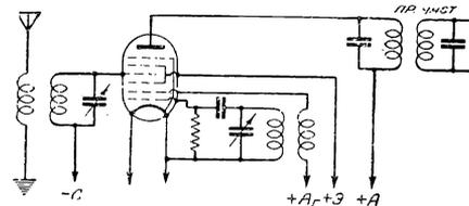
Рис. 2. Схема включения пентагрида
