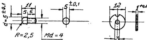
Рис. 12. Шпильки
